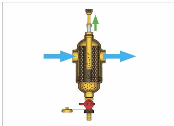
Подождать несколько минут, затем открыть сливной кран, поворачивая его против часовой стрелки и слить жидкость в специально подготовленную емкость.
