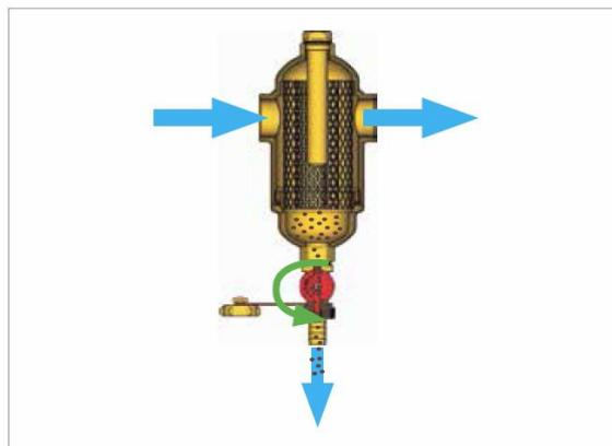
После удаления шлама закрыть сливной кран и вставить магнит обратно в контейнер, вращая его против часовой стрелки.
