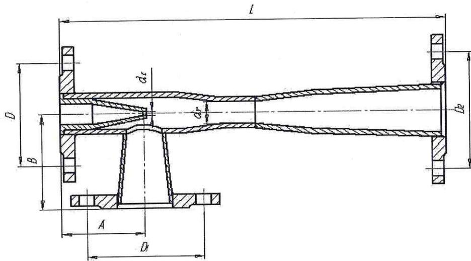
Материал корпуса, диффузора, фланцев и сопла – сталь.
