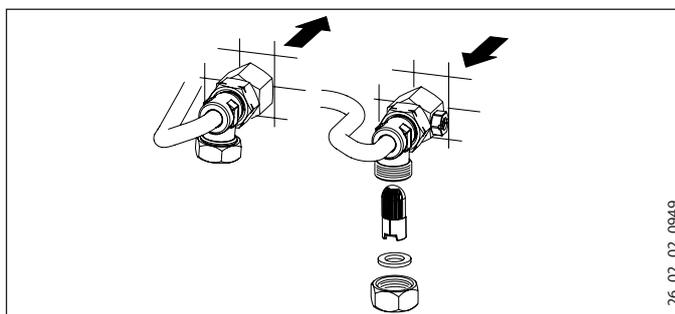
Очистить сетчатый фильтр в резьбовом соединении трубопровода холодной воды. Закрывать запорный вентиль в трубопроводе подачи холодной воды, демонтировать сетчатый фильтр, очистить его и установить снова.
