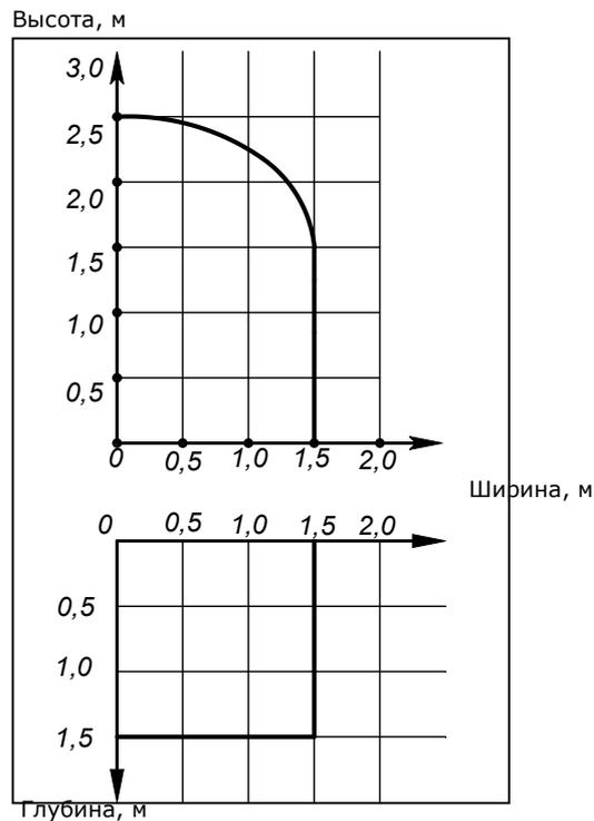
Эпюра распределения воды оросителями «СВГ-15», «ДВГ-15» при установке горизонтально
