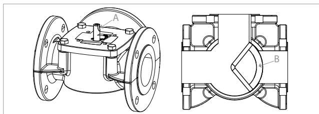
Затвор клапана с приводом, может перемещаться на 90° по часовой стрелке и против часовой стрелки для обеспечения подачи от входа клапана (A) к одному из двух доступных выходов (B или C).
