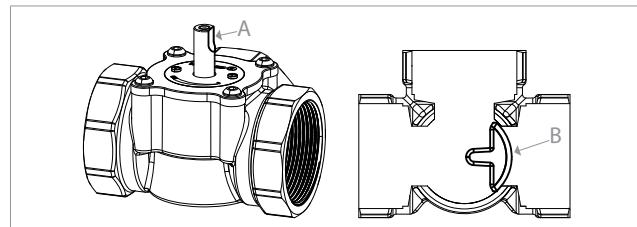
Затвор клапана может поворачиваться на 90° в обоих направлениях (по и против часовой стрелки); поэтому, исходя из начальной настройки точки, он может перемещаться в диапазоне 180°.
