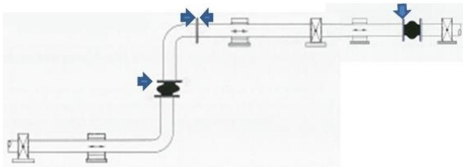
В случае монтажа компенсатора вблизи насоса, расстояние от компенсатора до патрубка насоса должно составлять  $1,5 \times DN$ .
