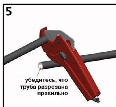
6.6 Порядок выполнения аксиального (надвижного) соединения с помощью ручного инструмента показан на рисунках 6...16:
