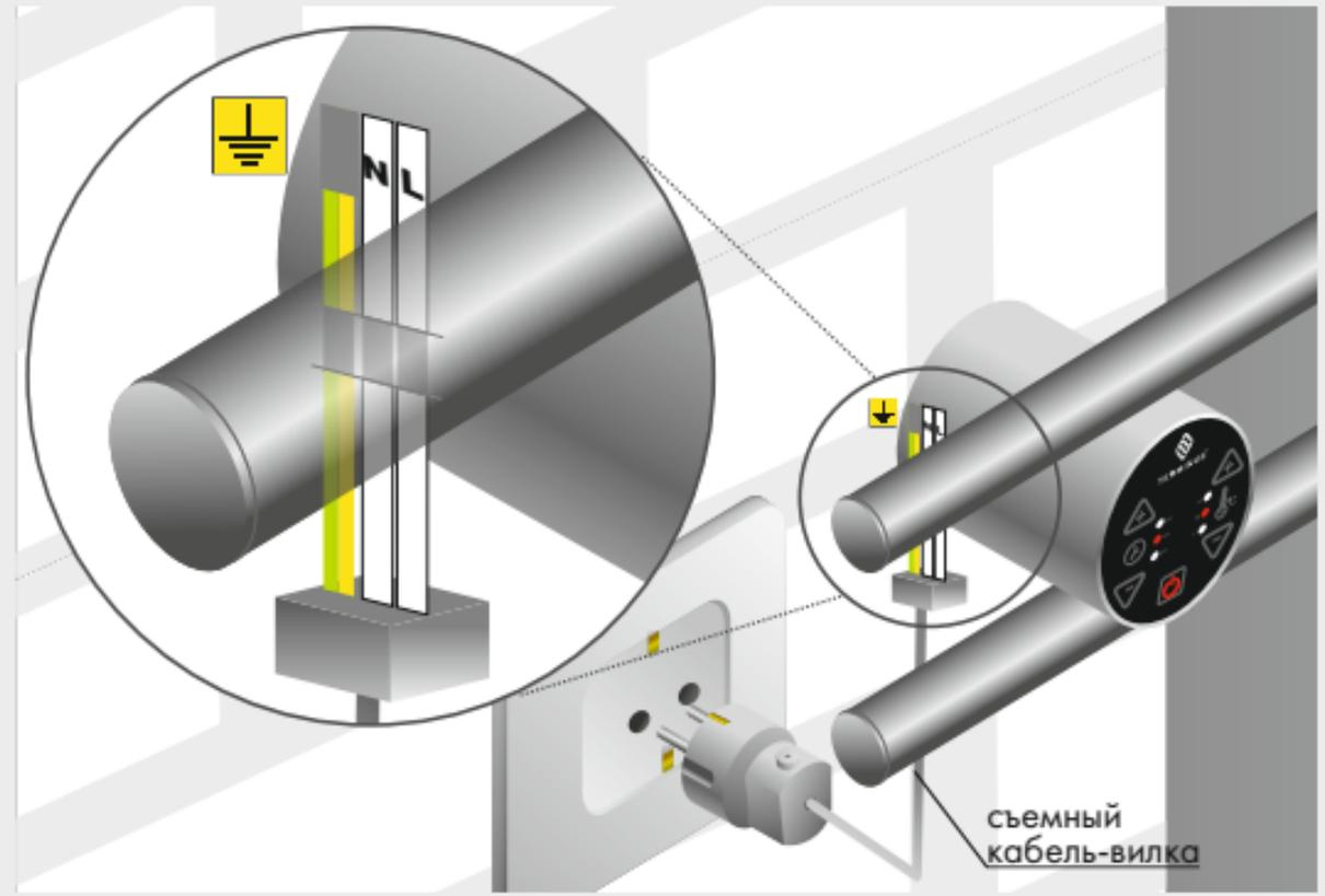
Уберите узел подключения проводов внутрь корпуса в зону, обозначенную штрихом на рисунке.
