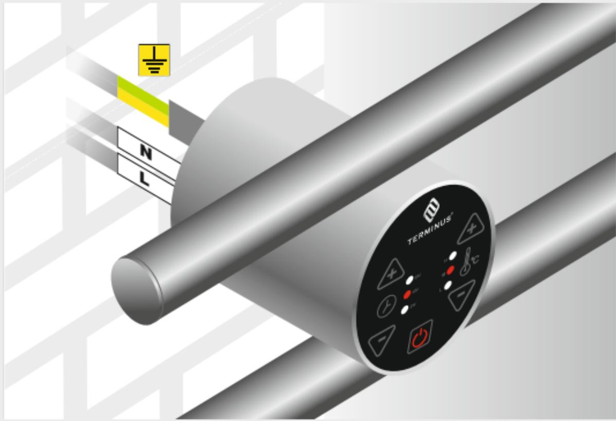
Схема 2. Подключение при помощи кабель-вилки
