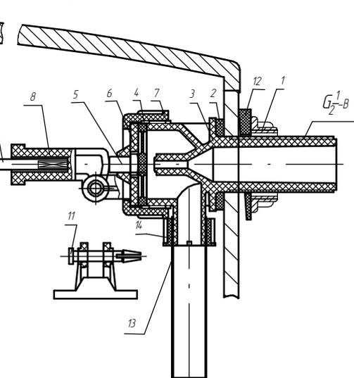
Рис. 2 Клапан наполнительный
