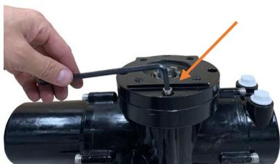
Шестигранным ключом 6мм (не идет в комплекте) открутить четыре крепёжных болта фланца привода
