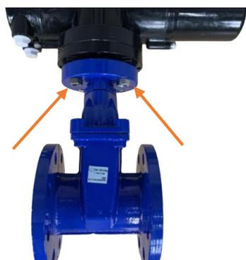
Необходимо установить запорную арматуру с безрезьбовым фланцем на фланец привода и произвести подтяжку гайками крепёжных болтов
