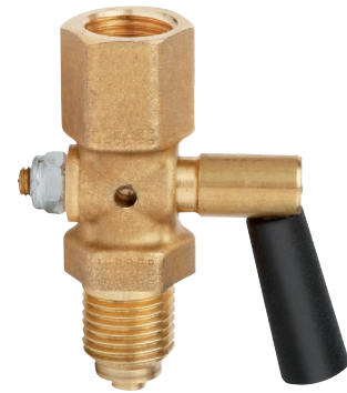
Запорный кран Внутренняя/внешняя резьба G 1/2/G 1/2 B, DIN 16261, PN 25
