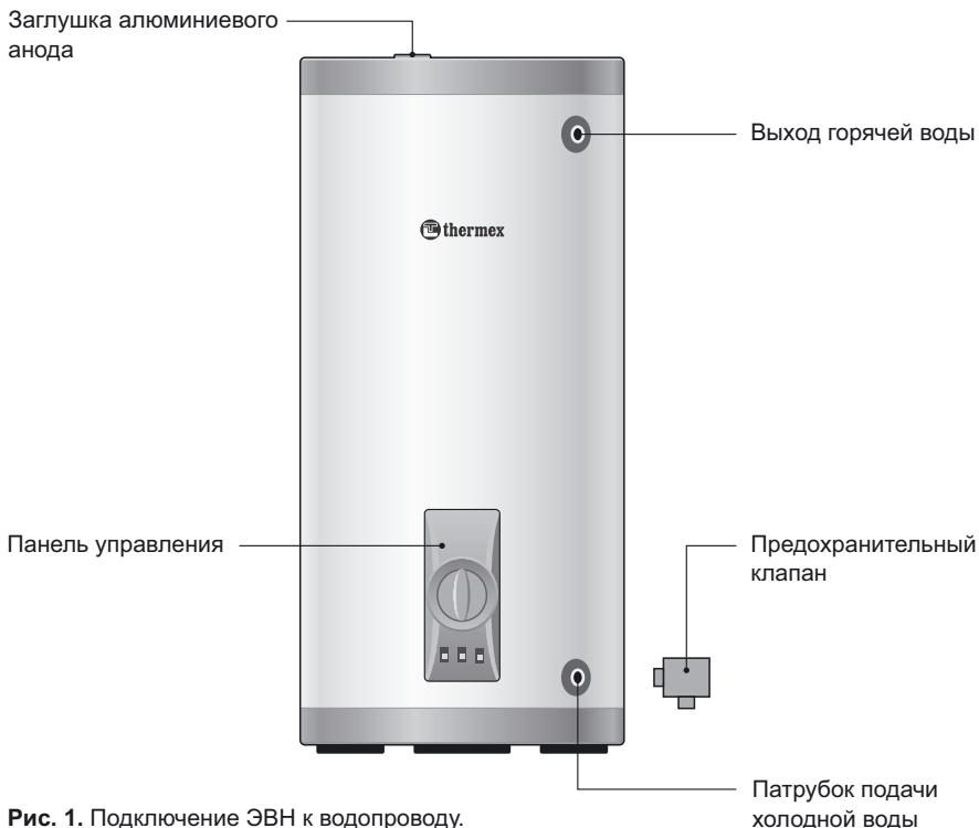
Рис. 1. Подключение ЭВН к водопроводу.
